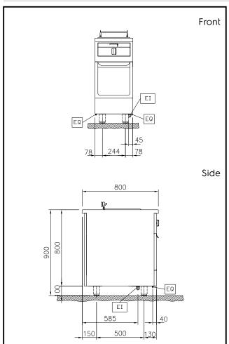
Electrical inlet (power) EQ **Equipotential screw**
